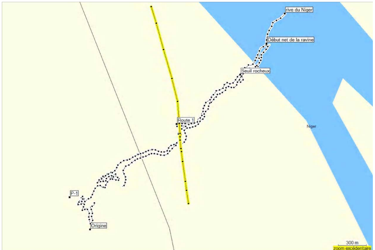
Figure 2 : Le relevé de la ravine avec le GPS simple (noter que la route ainsi que le fleuve Niger est mal positionné sur le fond de carte fourni avec le GPS).
