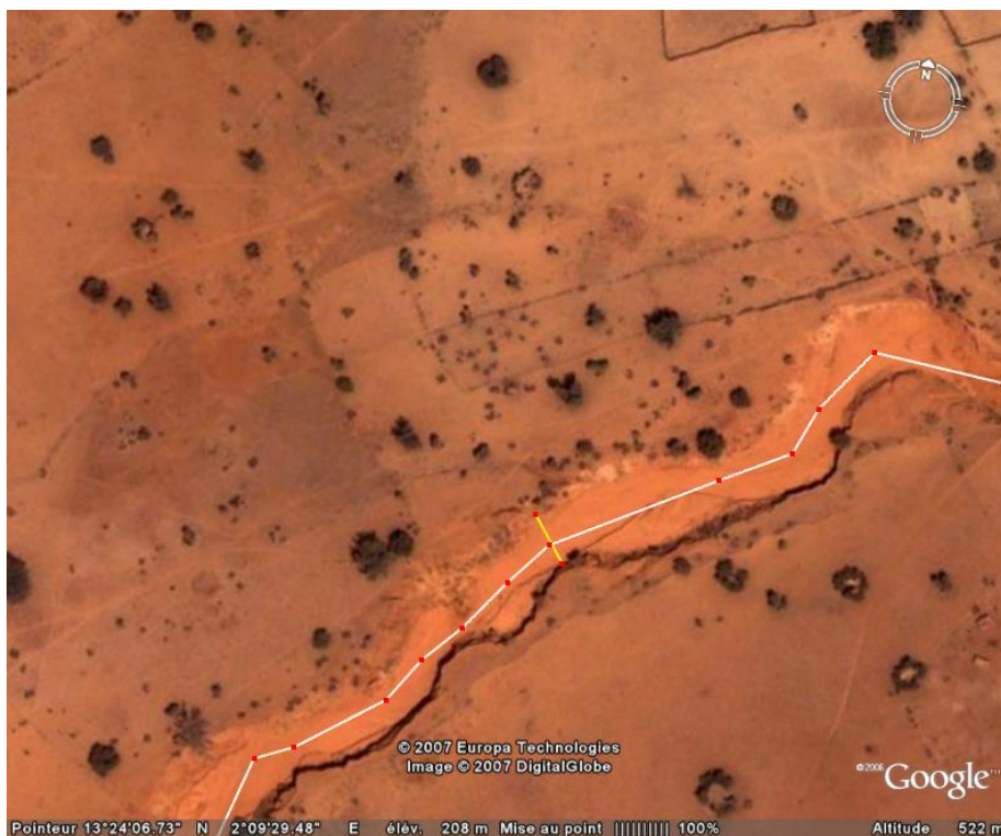
Figure 4 : Exemple de mesure de la longueur et de la largeur de la ravine avec Google Earth.
