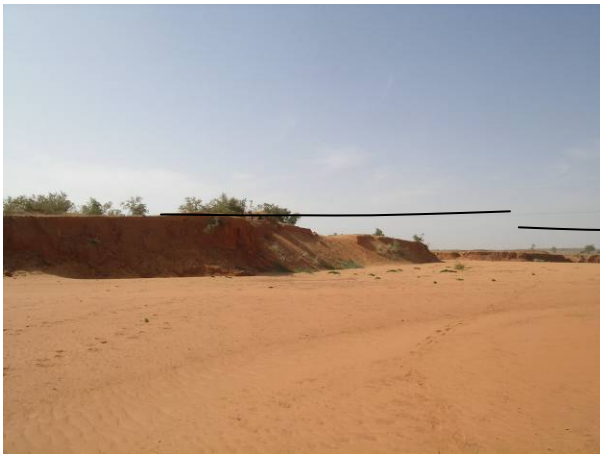
Figure 3. Mesure de la profondeur avec la méthode de la corde.
